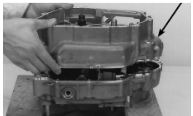
Certifique-se de que as superfícies de contato da carcaça do motor apresentem contato uniforme.
