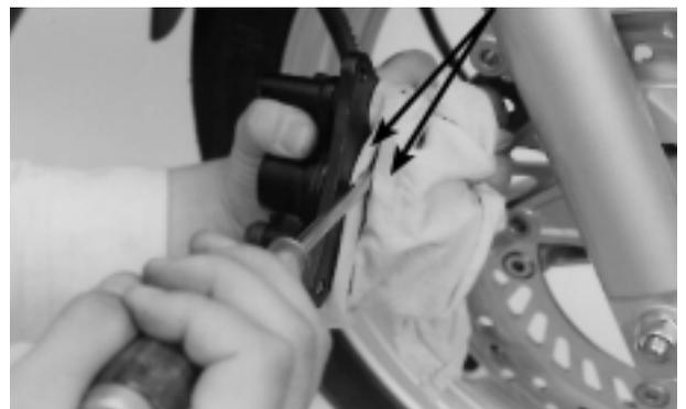
Instale o cliper do freio no garfo esquerdo, de modo que o disco de freio fique posicionado entre as pastilhas.
