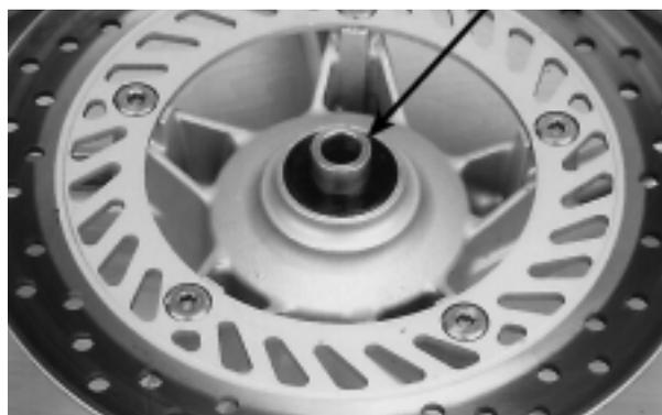
Remova a caixa de engrenagens do velocímetro do lado esquerdo do cubo da roda.
