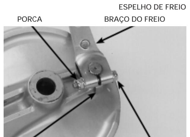
PLACA INDICADORA DE DESGASTE PARAFUSO
