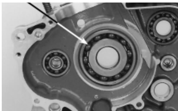
Remova os rolamentos do balanceiro, utilizando as ferramentas especiais.
