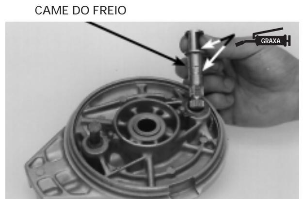
Instale a placa indicadora de desgaste no came do freio, alinhando seu estriado mais largo com a ranhura larga do came do freio.
