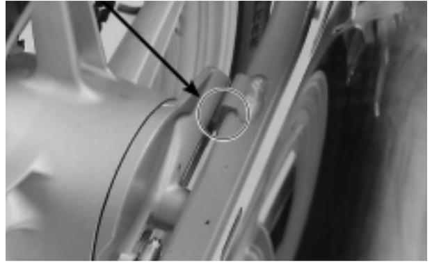
Posicione a roda traseira no chassi e insira o eixo traseiro pelo lado esquerdo, através do ajustador esquerdo da corrente de transmissão, do espaçador lateral esquerdo e do ajustador direito.
