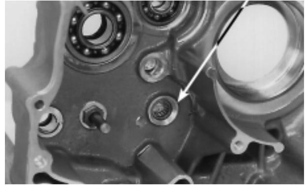
Após instalar os rolamentos, instale o novo retentor de óleo da árvore secundária.
