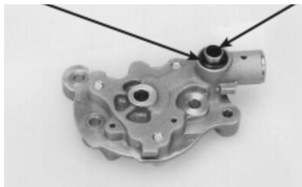
Remova os três parafusos e a tampa da bomba de óleo.
