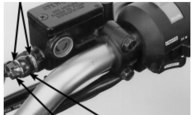
PARAFUSO DE CONEXO CONEXO DA MANGUEIRA
