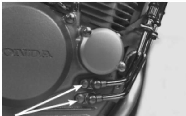
PARAFUSOS/TUBOS DE ÓLEO/ANÉIS DE VEDAÇÃO
