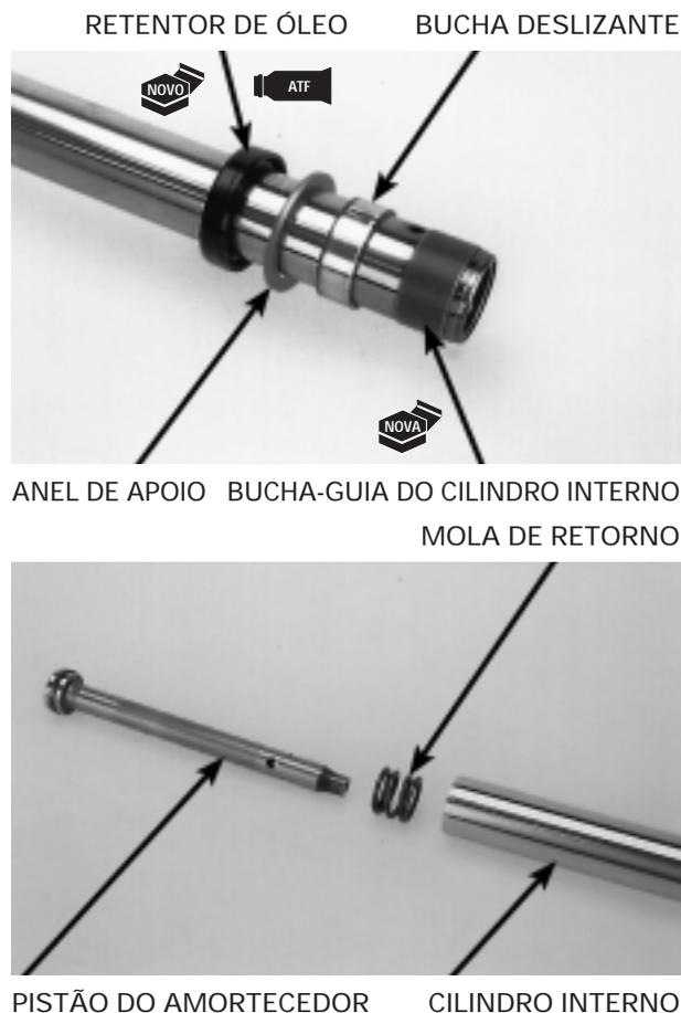
Instale o vedador de óleo na extremidade do pistão do amortecedor.
