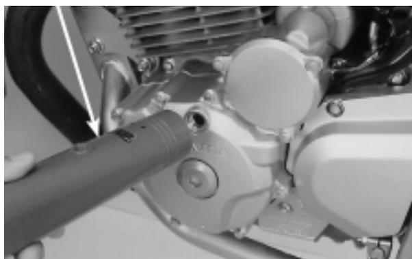
O ponto de ignição estará correto se a marca "F" no rotor do gerador de pulsos da ignição estiver alinhada com o entalhe de referência da tampa da carcaça do motor, conforme mostrado.
