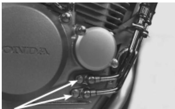
PARAFUSOS/TUBOS DE ÓLEO/ANÉIS DE VEDAÇÃO
