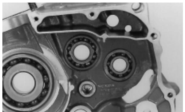
Inspeccione o rolamento de agulhas quanto a desgaste ou danos. Substitua, se necessário.
