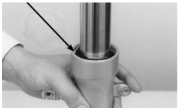
Aplique o fluido para suspensão recomendado no lábio do novo retentor de pó e instale-o no cilindro externo.
