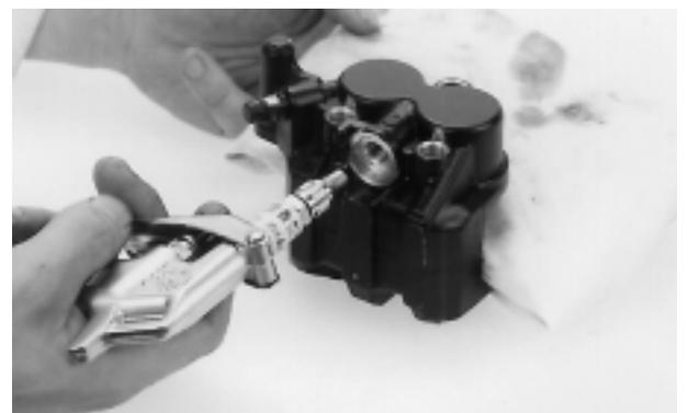
Pressione os retentores de pó e os selos dos pistões e levante-os para retirá-los.
