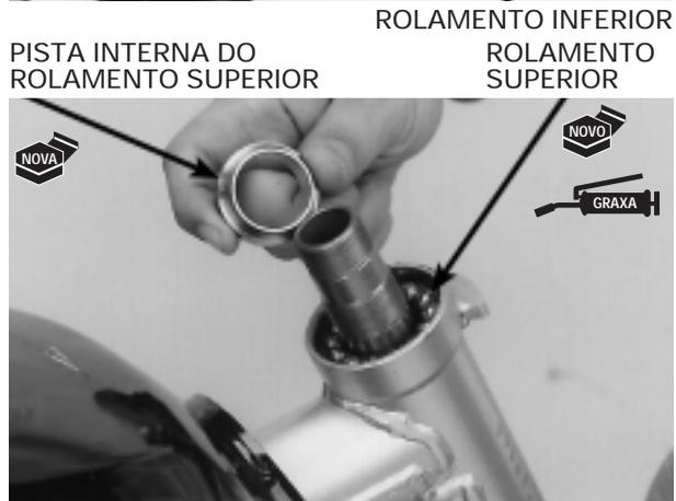
Instale a porca de ajuste da coluna de direção e aperte-a manualmente. Em seguida, aperte-a no torque inicial.
