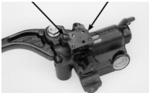
Remova a porca, o parafuso de articulação e a alavanca do freio dianteiro.
