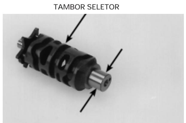
Inspeção o mancal do tambor seletor na carcaça direita do motor quanto a desgaste excessivo ou danos.
