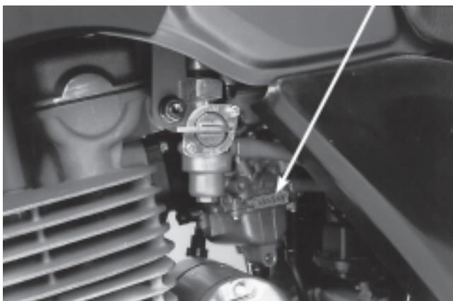
O número de identificação do carburador está gravado no lado esquerdo do corpo do carburador, conforme mostrado.
